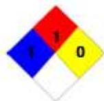
Identificación de riesgos de materiales según NCh 1411
